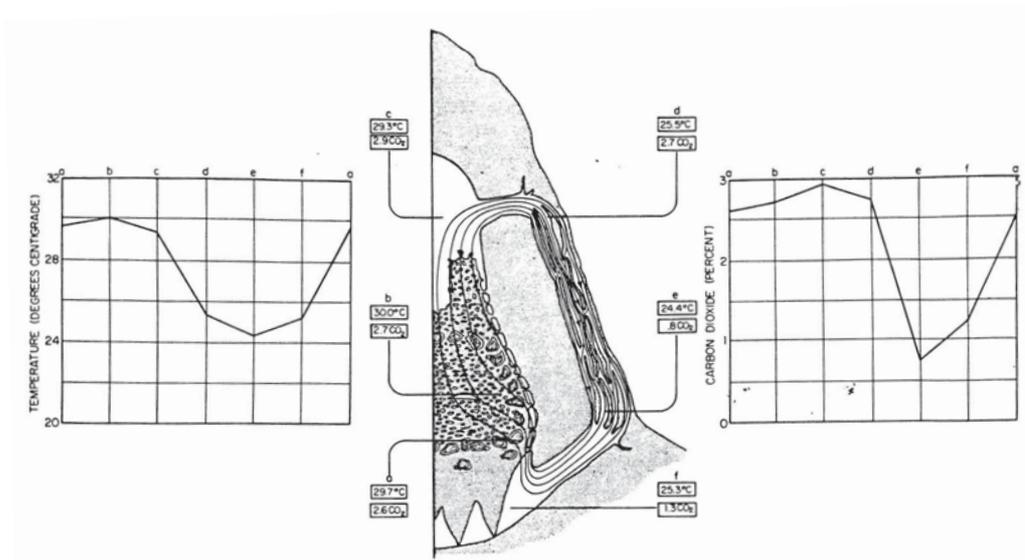
Fig. 3. O fluxo de ar garante o controle do microclima no interior do ninho dos *Macrotermes bellicosus*. O metabolismo dos insetos dentro dos compartimentos eleva a temperatura do ar, que circula, sendo resfriado em contato com as paredes dos canais existentes na estrutura externa. O sistema serve também para reduzir a porcentagem de CO<sub>2</sub> do ar interno (desenhos baseados em Lüscher, in Wilson, *The insect societies*, e Turid Hölldobler, in Frisch, *Animal architecture*).
