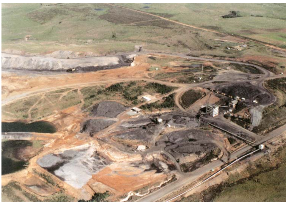
Mina de Candiotá: mina a céu aberto da Companhia Riograndense de Mineração. Vê-se ao fundo, à esquerda, áreas já recuperadas após a lavra.
