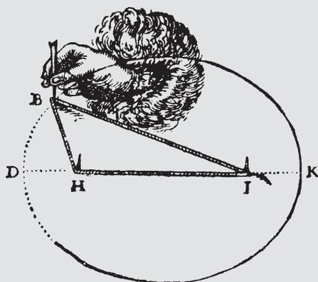
igual, a fim de mantê-la igualmente tensionada e de descrever desse modo sobre a terra a linha curva  $DBK$ , que é uma elipse. E se, sem mudar o comprimento dessa corda  $BHI$ , cravam as estacas  $H$  e  $I$  um pouco mais próximas uma da outra, eles descreverão novamente uma elipse, mas que será de um tipo diferente da precedente; e se eles as colocam ainda um pouco mais próximas, [167] descreverão ainda uma outra; e, enfim, se eles as juntam, será um círculo que eles
