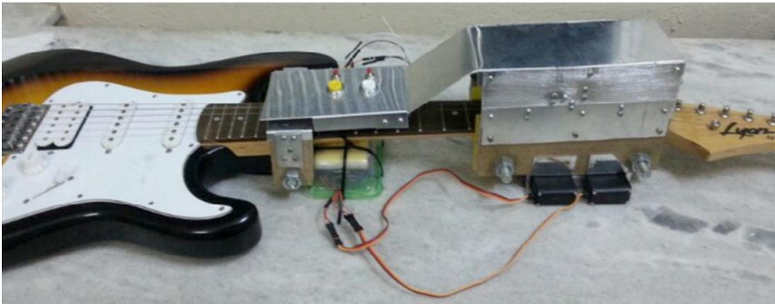
**Figura 5** - Protótipo do Suporte Facilitador de Acordes posicionado em uma guitarra
