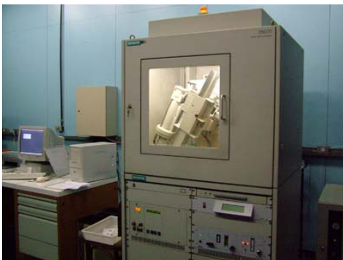
FIGURA 3 – Difratorômetro de raios X Siemens, modelo D5000, do Instituto de Geociências da USP.
