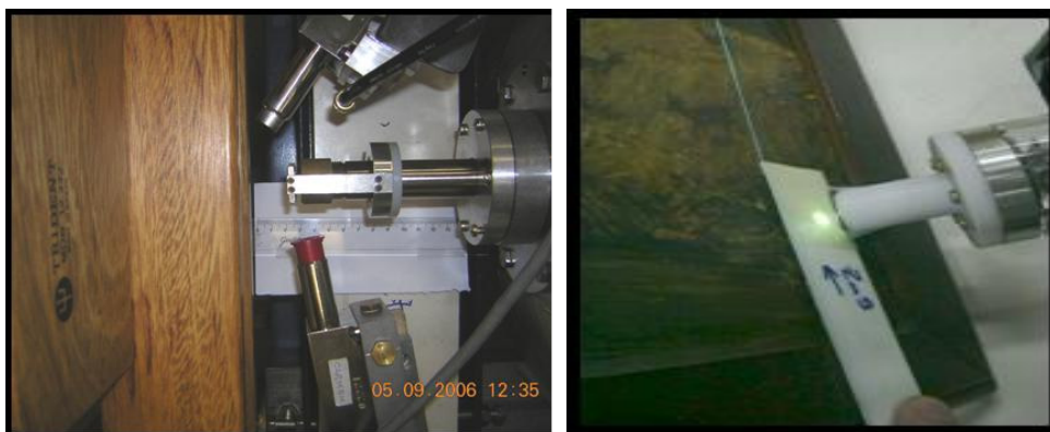
FIGURA 2 - Foto à esquerda mostra o arranjo de feixe externo com os detectores de raios-X. Na figura à direita temos o arranjo de feixe externo em uma análise de uma pintura; e em detalhe o feixe sobre pó de SZn que o torna visível.
