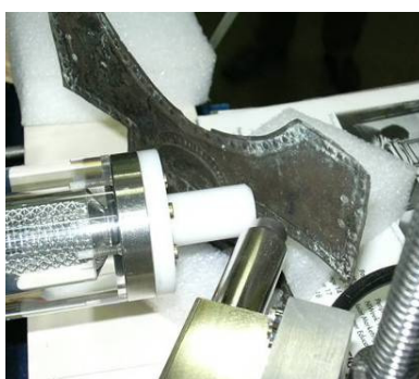
FIGURA 3 - Foto à esquerda mostra o arranjo de feixe externo na análise de uma peça metálica do MAE/USP. Na figura à direita temos um espectro típico PIXE.
