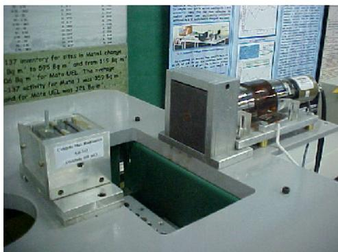
FIGURA 3 - Mesa de transmissão de raios gama com fonte de  $^{241}\text{Am}$ , com movimentação XZ micrométrica da amostra e sistema automatizado de tomada de dados.
