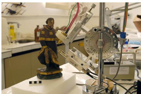
FIGURA 10 - O sistema portátil de EDXRF posicionado para a medida de uma escultura em madeira policromada, no Laboratório de Conservação do MAE/USP.
