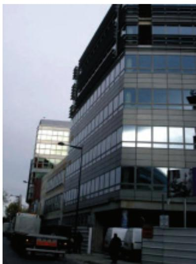
Figura 2: Fachada-cortina constituída de quadros estruturantes em perfis de alumínio, placas de vidro insulado (parte superior) e placas de alumínio (parte inferior) intercaladas por isolante
