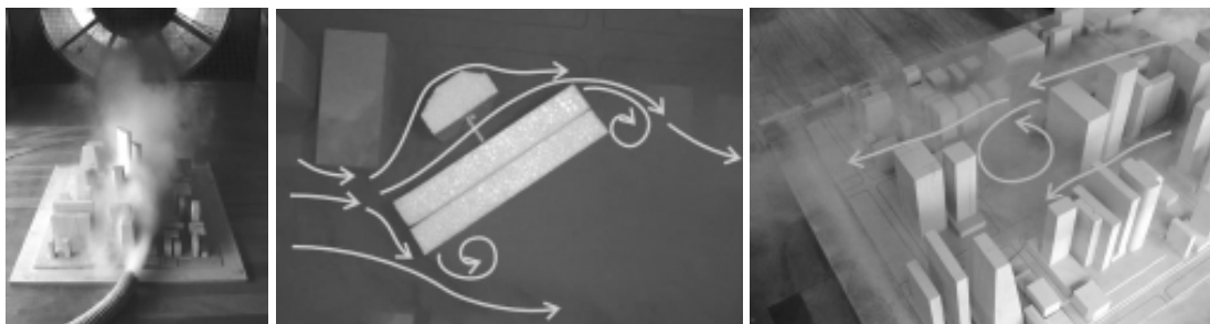
Figura 5 – Ensaio de impacto provocado por um edifício alto, no padrão de vento Fonte: TFG Thiago Hernandes – Projeto de Edifício Alto para São Paulo
