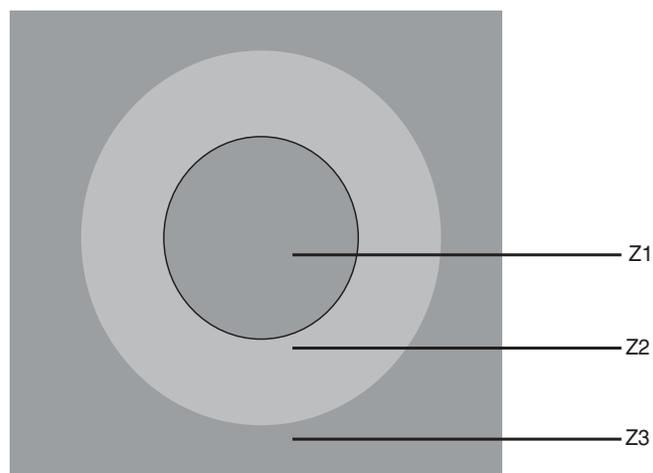
**FIGURA 1** - Desenho esquemático apontando como foram classificadas as zonas morfológicas relacionadas às microcavidades. Z1 = centro da microcavidade, onde o material foi ablacionado; Z2 = zona intermediária que pode ou não existir; Z3 = região do material que não recebeu influência alguma da irradiação.
