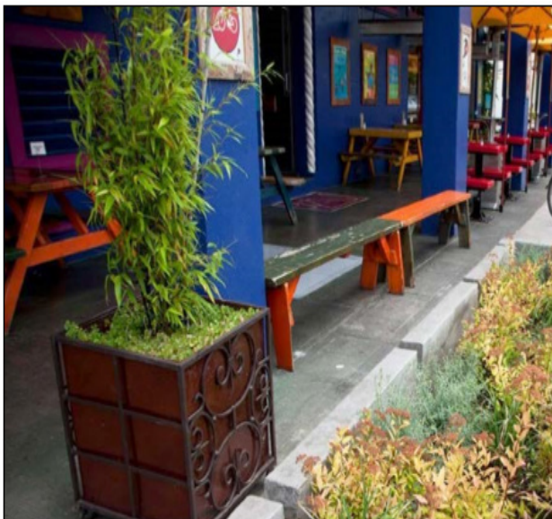
Figura 7 – Sarjetas verdes são áreas de paisagem do lado da rua que armazenam, filtram e infiltram o escoamento de águas pluviais. Fonte: Portland (2016).
