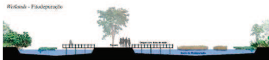
Figura 21 Corte Wetlands – Trecho VI do detalhamento do projeto. Fonte: Lourenço (2013, p. 158).
