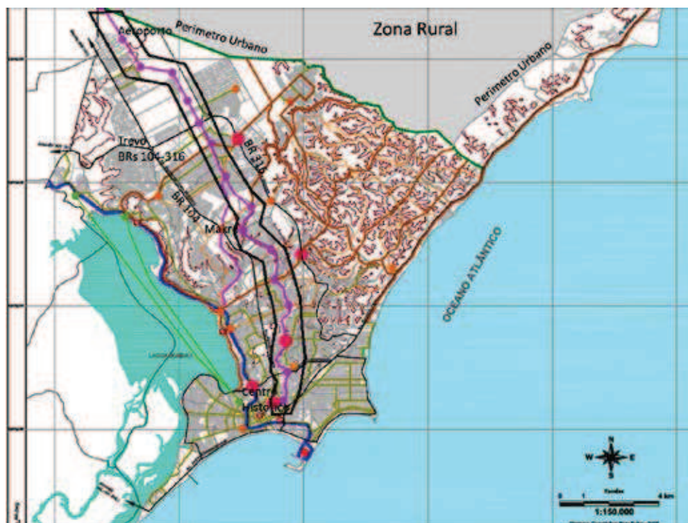
Figura 3 Eixos de mobilidade previstos no Plano Diretor de Maceió (2005). Observar as novas vias previstas para expansão urbana, a nordeste, e o eixo Sul-Norte de transporte de massa, inserido no Vale do Reginaldo, com as estações assinaladas.
