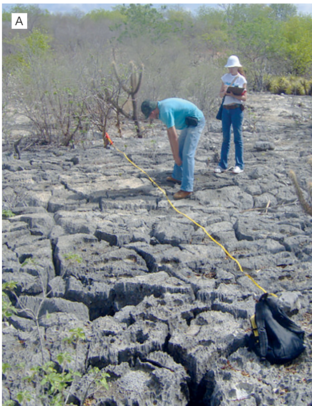
Figura 8. (A) e (B) Levantamento sistemático do parâmetro abertura em juntas tectônicas no lajedo de Arapuá.
