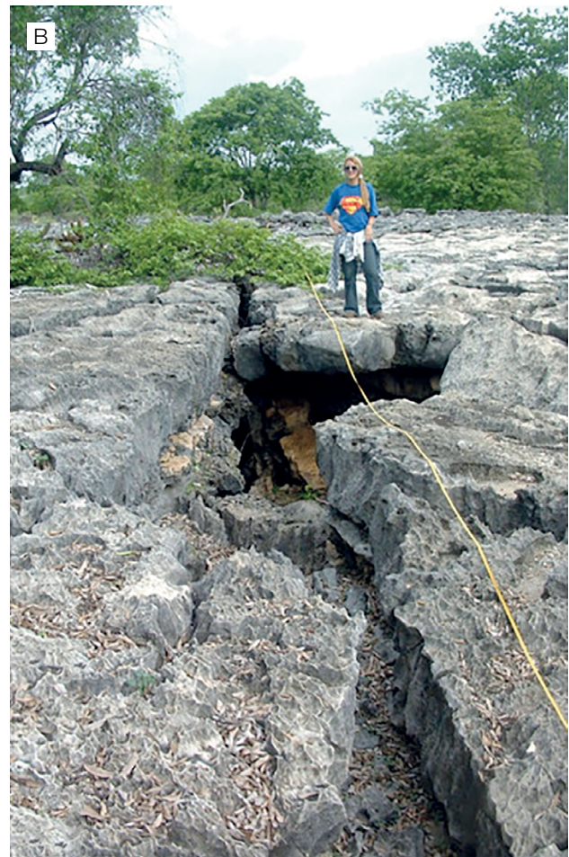
Figura 9. (A) e (B) Levantamento sistemático do parâmetro persistência ou continuidade de juntas J_3 (NE-SW) controlando a formação de ravinas e abrigos no lajedo de Arapuá.
