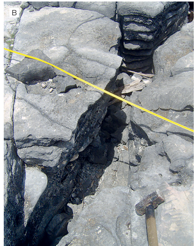
Figura 8. (A) e (B) Levantamento sistemático do parâmetro abertura em juntas tectônicas no lajedo de Arapuá.
