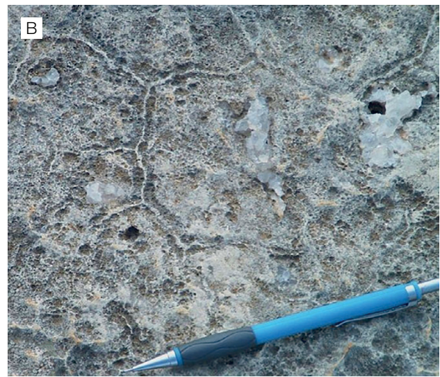
Figura 5. (A) Sistema de fraturas tectônicas sem movimento aparente, evidenciado por juntas abertas, resultado do afastamento das paredes das fraturas. Ocorrem na área tanto juntas persistentes, com comprimento excedente aos limites de exposição da rocha, como não persistentes, com terminações em outras discontinuidades; (B) juntas não tectônicas representadas por gretas de contração.
