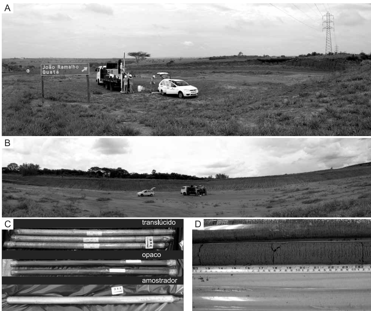
Figura 2. Perfuratriz hidráulica Geoprobe® montada sobre caminhão da American Drilling do Brasil Ltda., nas localidades das seções de referência Rancharia (A) e Oriente (B). Amostrador e tubos do tipo liner translúcido e opaco após a coleta dos sedimentos, desenvolvido pela Brasbailer Indústria e Comércio de Produtos Plásticos Ltda (C). Liner translúcido com sedimentos da Aloformação Paranavaí da seção de referência Oriente após abertura (D).
