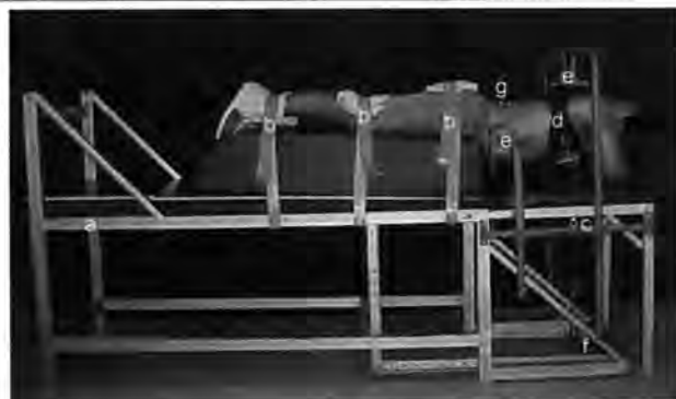
Figura 1 Postura e equipamentos utilizados para os testes de Contração Isométrica Voluntária Máxima (CIVM) e de exaustão. a = mesa de teste; b = cintos de couro; c = célula de carga; d = colete; e = limitadores de movimento; f = indicador digital; g = eletrodos
