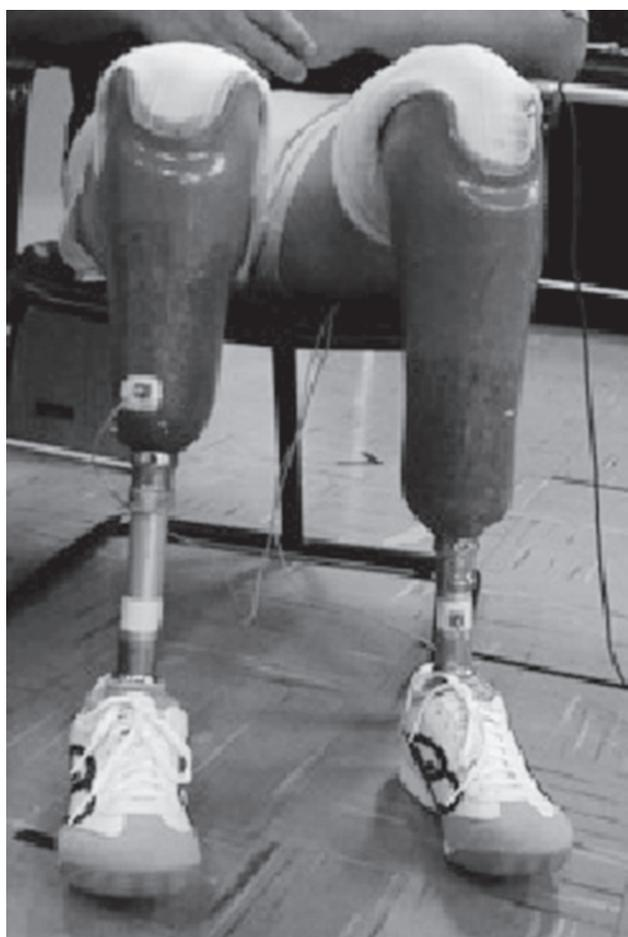
**Figura 1** Prótese direita: fixação do acelerômetro no encaixe protético. Prótese esquerda: fixação na haste metálica. Durante as coletas os dois acelerômetros foram fixados no mesmo local para ambas as próteses.
