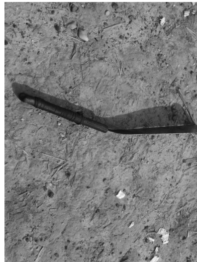
Figura 3 - Facão adaptado para facilitar o corte e facão sem entortar
