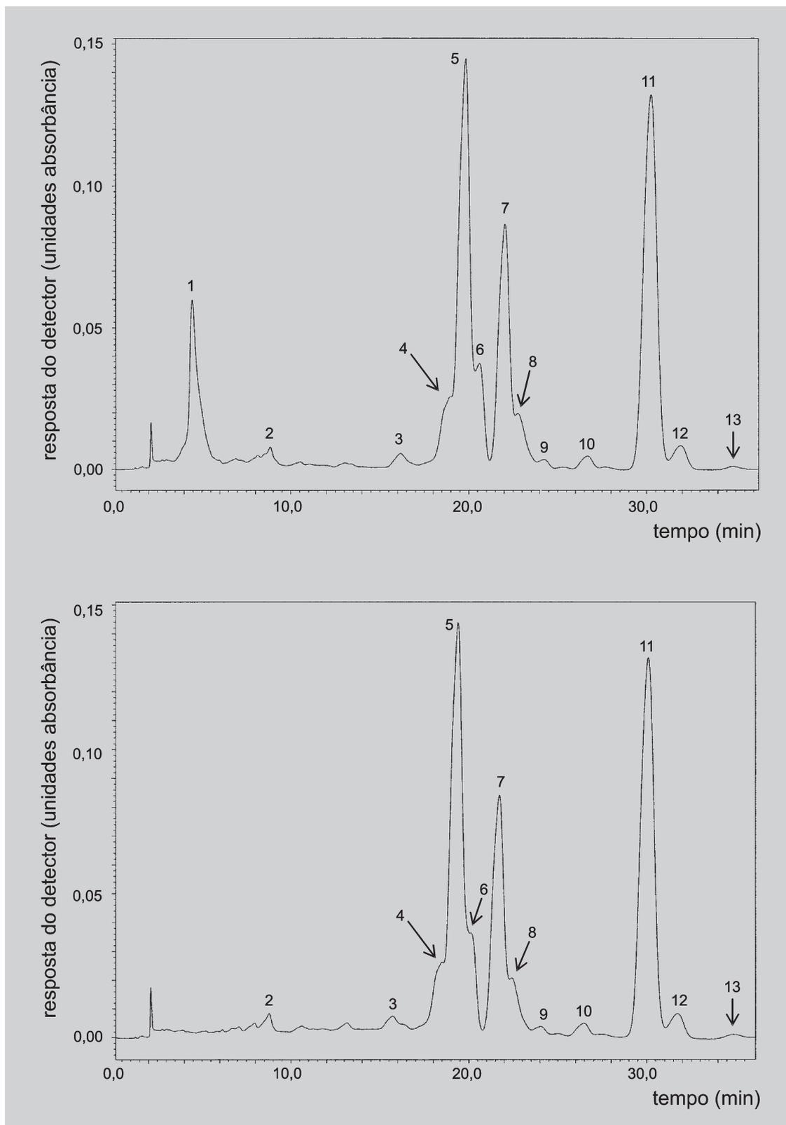
**FIGURA 1** - Cromatograma, obtido por CLAE, dos carotenóides de *R. glutinis*. Condições: coluna Novapack  $C_{18}$  (4  $\mu$ m, 4.6 x 300 mm), fase móvel acetonitrila/metanol (0,1% trietilamina)/acetato de etila (75:15:10), vazão de 1 ml/min e temperatura da coluna de 29 °C; **a**- com eluição de metanol (0,1% trietilamina) por 1 minuto entre as injeções, **b**- sem eluição de metanol entre injeções. A identificação dos picos encontra-se na Tabela I.
