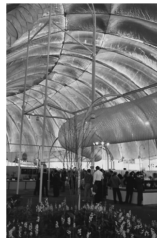
図2.3 エアドーム内観 第1ドーム(上)・第2ドーム(下) ダクトを設けると上下空気の攪拌は少なく温度成層をなす。(第1・第2ドームとも)
