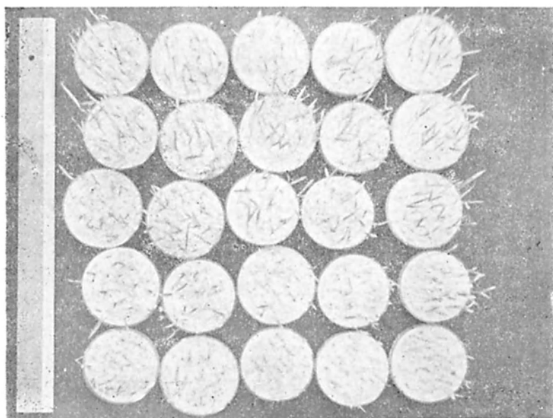
Fig. 4 — O conjunto de 25 cristalizadores ocupando uma área de 40x40 cm.
