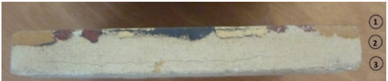
Figura 3 – Vista lateral de ladrilho hidráulico do Palácio da Justiça Federal no Rio de Janeiro (2010). Fonte: Arquivo pessoal.
