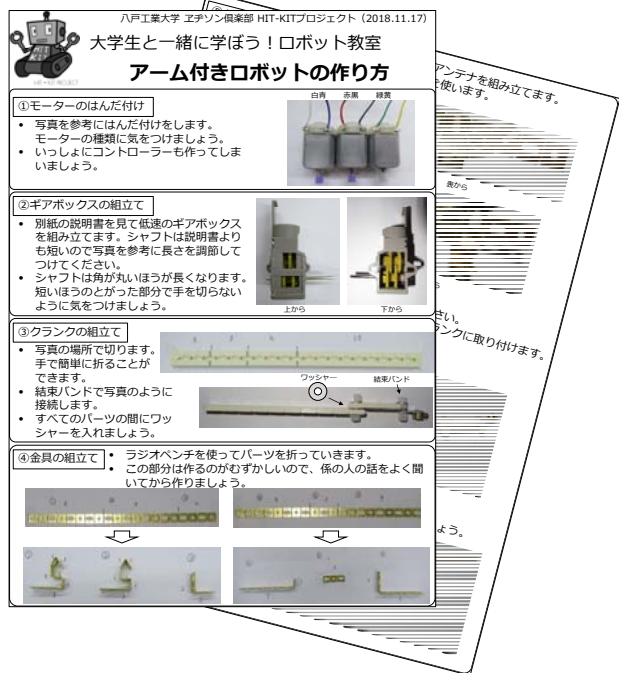
図1 アーム付きロボットキットの作り方
