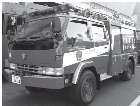
写真1 消防用高機動車の例 (救助工作車Ⅳ型スーパーダイナ)
