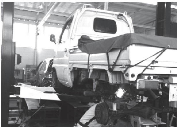
写真 2 リフトアップキット組み付け状況
