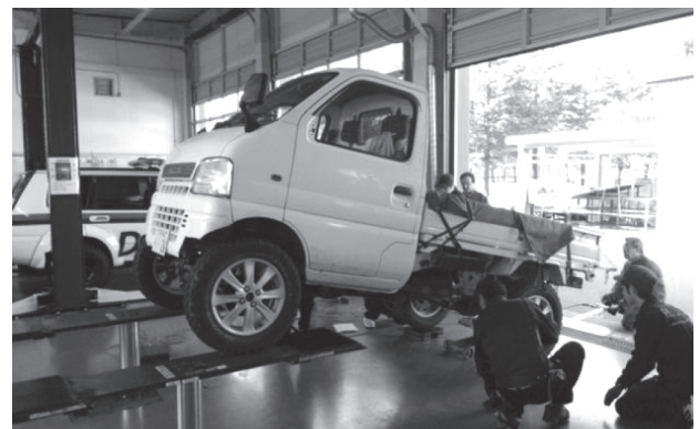
写真7 前輪揚程法による重心高測定の状況
