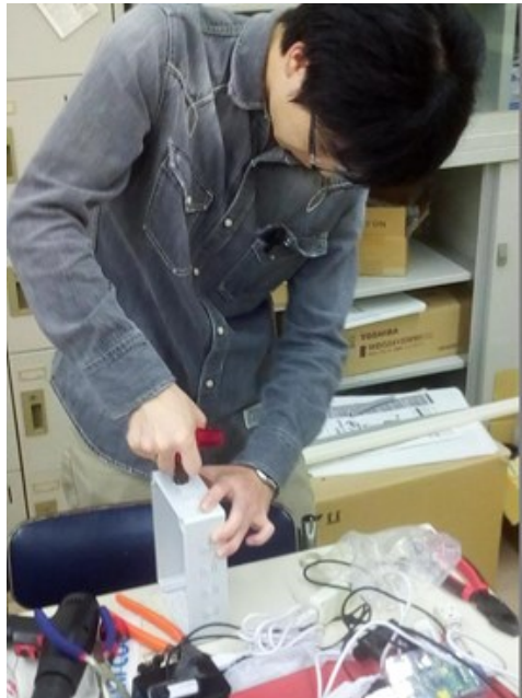
図 6 防水ケース内への機器の設置
