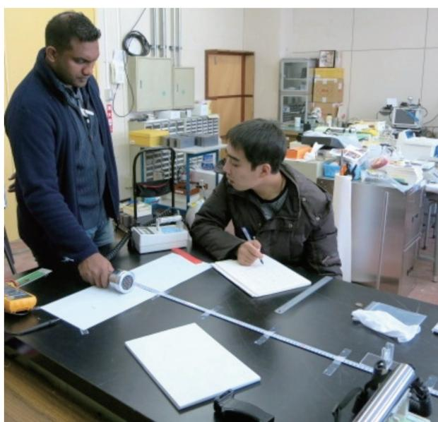
図3 標準線源を用いた放射線計測実験
