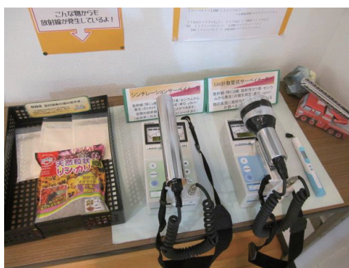
図 2.4 サテライト展示品（湯の花、リン・カリ肥料、シンチレーションサーベイメータ、GM サーベイメータ、家庭用放射線測定器）
