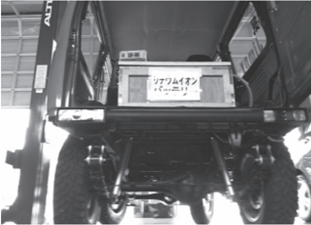
Fig.6 コンバージョン EV の駆動用蓄電池の配置
