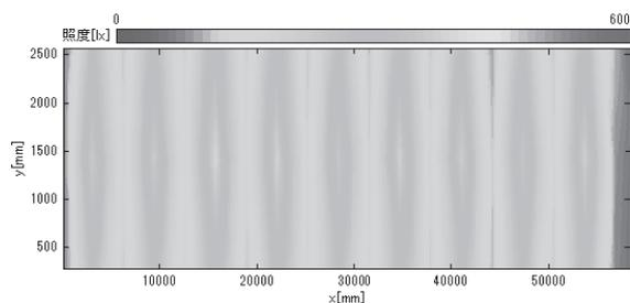
図3 廊下の照度測定結果 (LED照明導入後)
