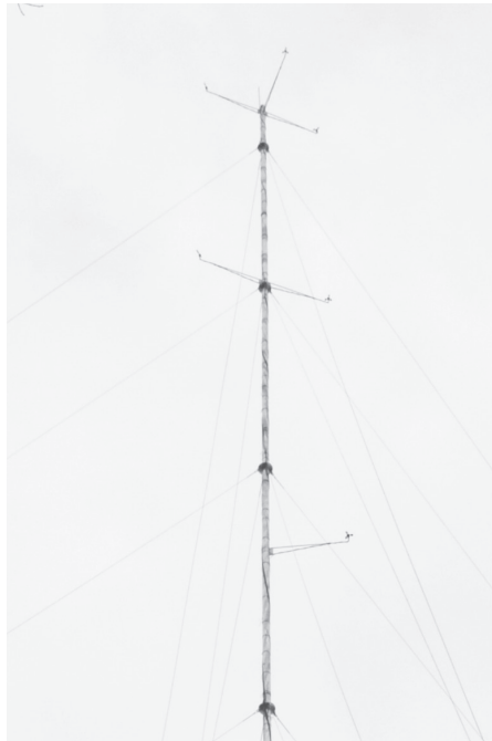
図6 設置された風況観測ポール（拡大）
