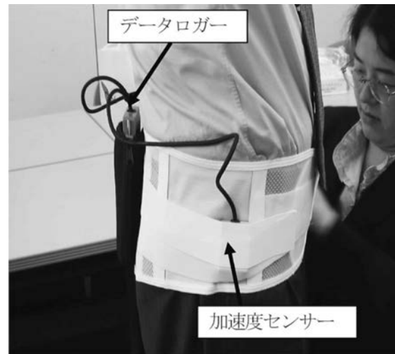
写真-2 データロガーの装着方法
