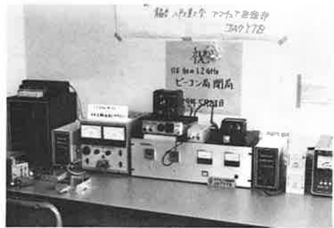
写真1 ビーコン局装置
