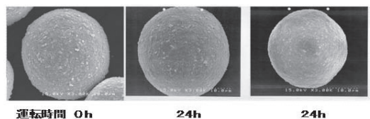
図6 30μm マイクロビーズの自己損耗特性
