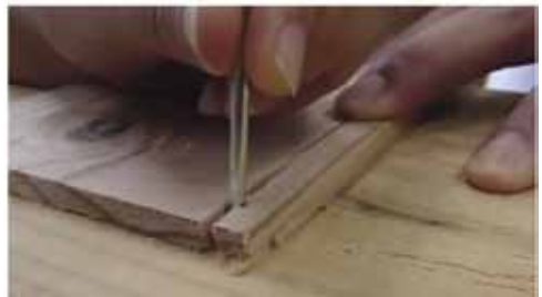
図1 釘打ちで板が割れる事例の動画
