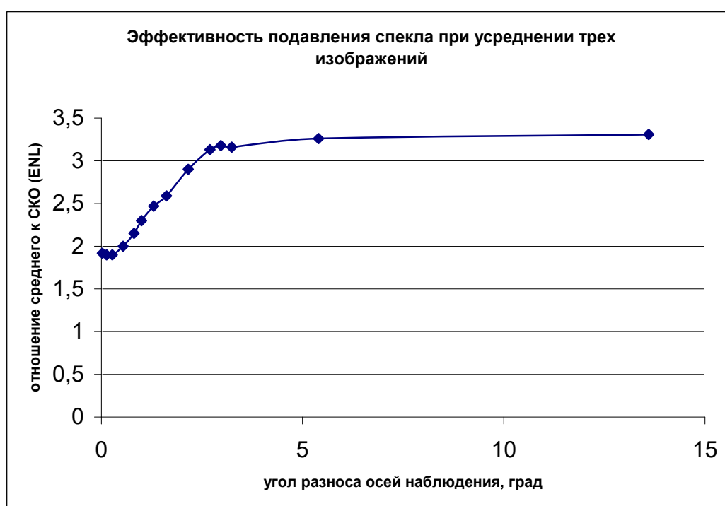
Рис. 3. Зависимость величины отношения средней яркости изображения к среднеквадратическому отклонению для различных углов разноса диаграмм направленности трех лучей РСА
