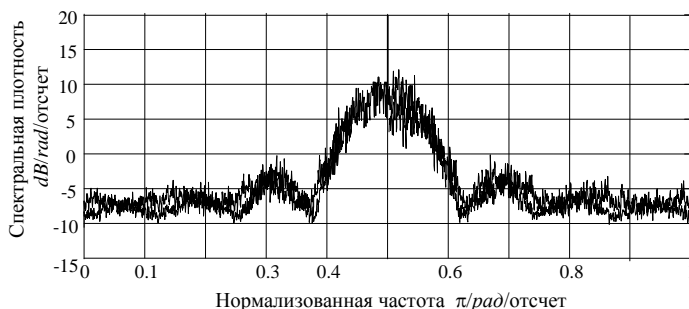
Рис. 1. Спектр ШПС сигнала: СПМ сигнала и СПМ сигнала после повторной модуляции ПСП
