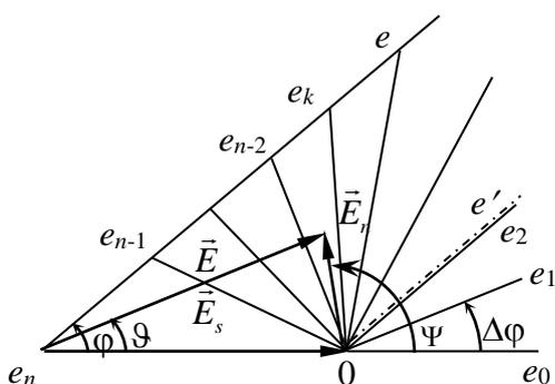
**Рис. 2.** К объяснению метода вычисления функции распределения фазы смеси сигнала и помехи
