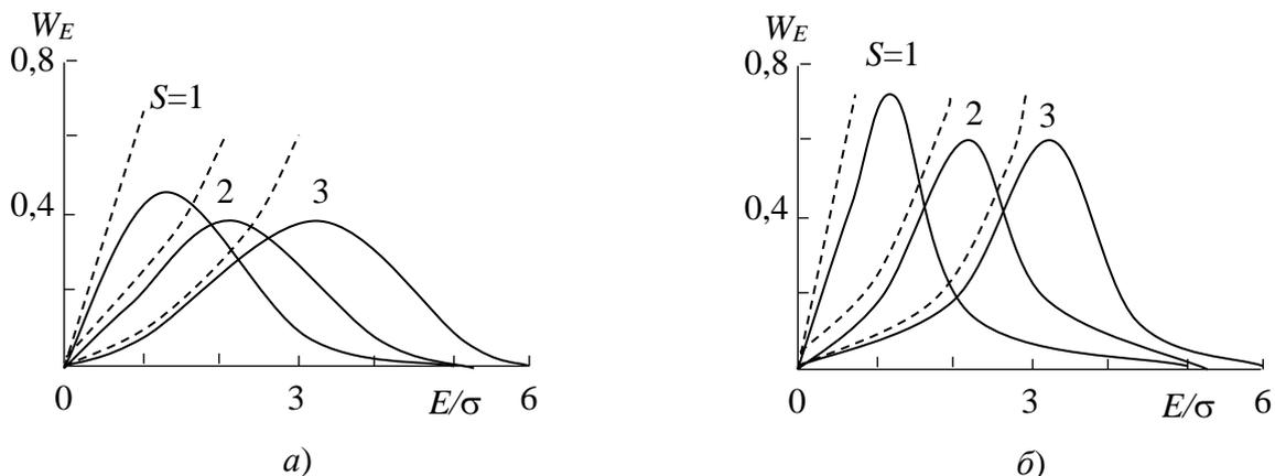
**Рис. 1.** Аппроксимация начального участка функции плотности вероятностей огибающей смеси сигнала с нормальной (а) и негауссовой (б) помехами
