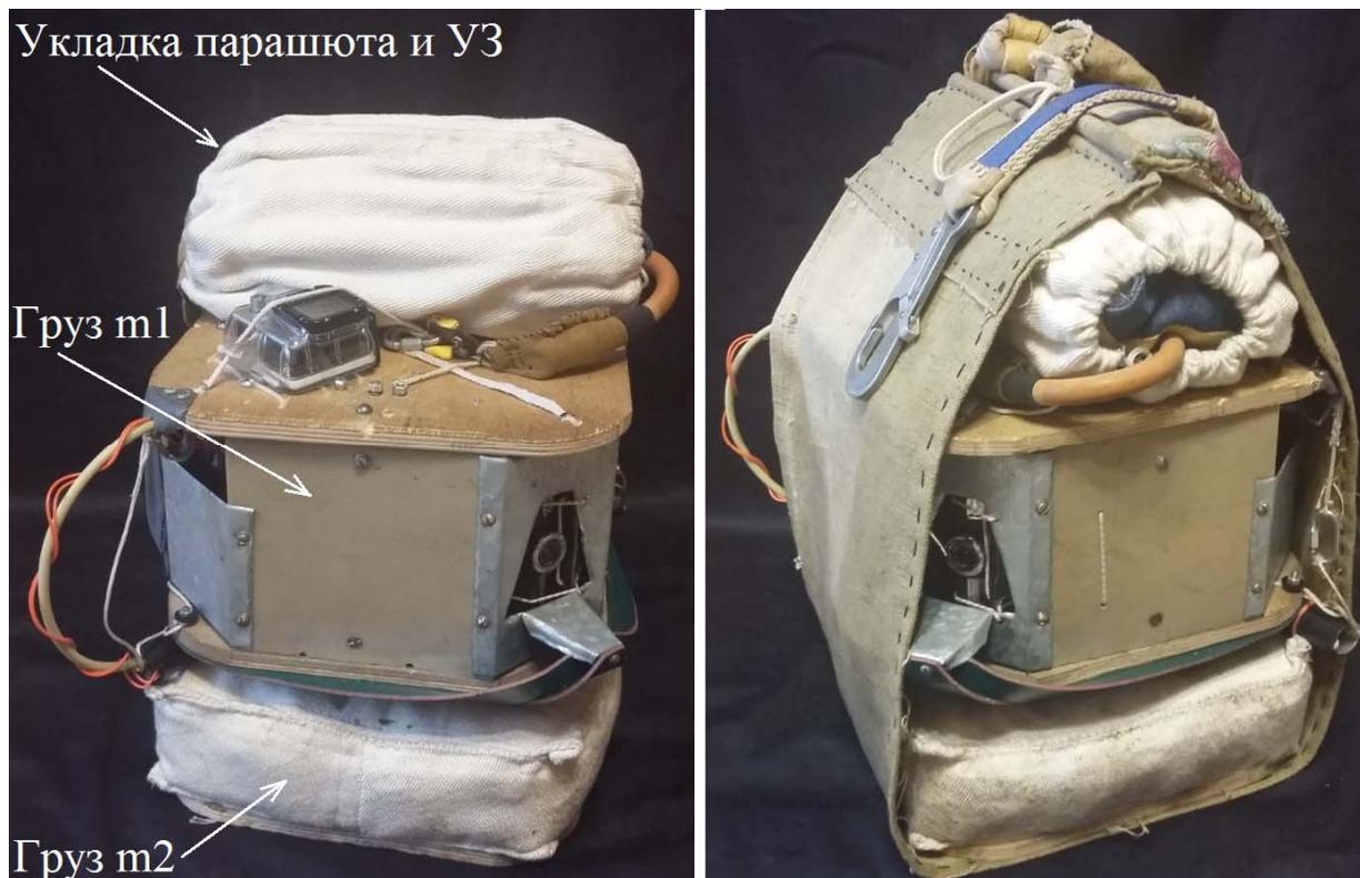
Рис. 3. Фотографии ПС в уложенном виде (слева) и подготовленной к летному эксперименту (справа)
