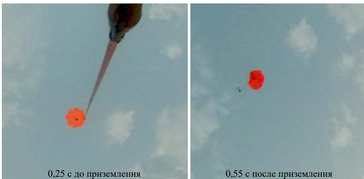
Рис. 5. Два кадра видеозаписи с верхней крышки груза m1 на парашют
