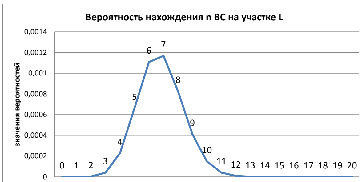
Рис. 3. Вероятностное распределение случайной величины нахождения n ВС на элементарном участке \ell на первой итерации
