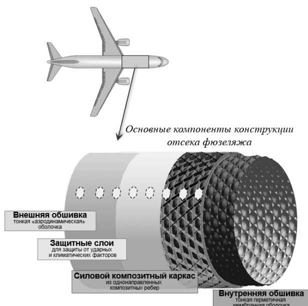
Рис. 3. Рациональная конструктивно-силовая схема цилиндрического отсека фюзеляжа на основе композитного каркаса Fig. 3. Rational design-power scheme of the cylindrical fuselage compartment based on a composite frame
