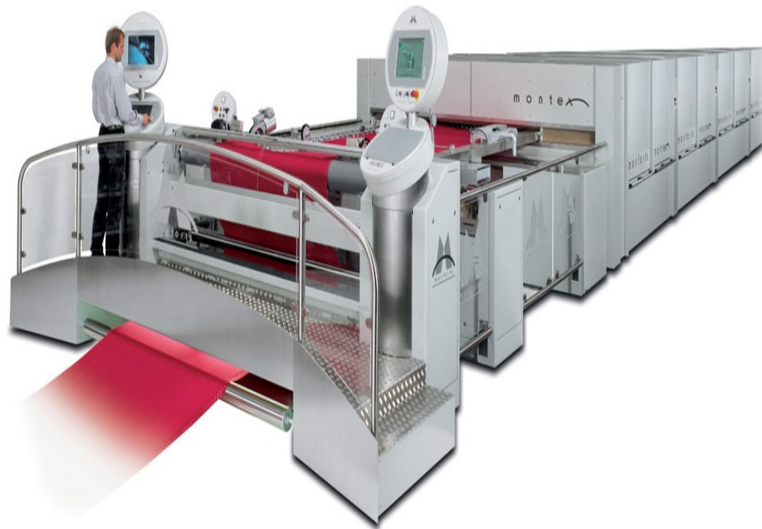
Figura 6. Rama tensora- máquina de acabado textil.
