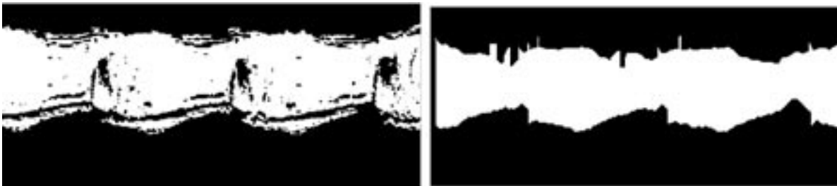
Figura 4. Extracción de la cavidad. (a) Cavidad extraída por medio de crecimiento de regiones (b) Procesamiento morfológico de la cavidad.
