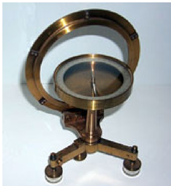
Figura 10. Aparato como el utilizado por Weber y Kohlrausch para medir la fuerza magnética
