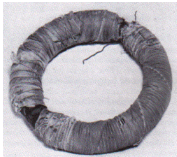
Figura 7. Experimento de Faraday sobre la inducción
