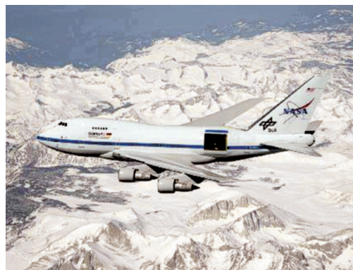
Figura 5. A la izquierda, el avión SOFIA 747SP dotado con un telescopio de infrarrojo de 2.7 m, que se muestra en más detalle en la fotografía de la derecha
