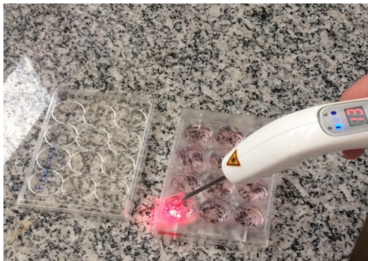
Figura 1: Irradiação dos poços com laser vermelho de baixa intensidade Fonte: o autor
