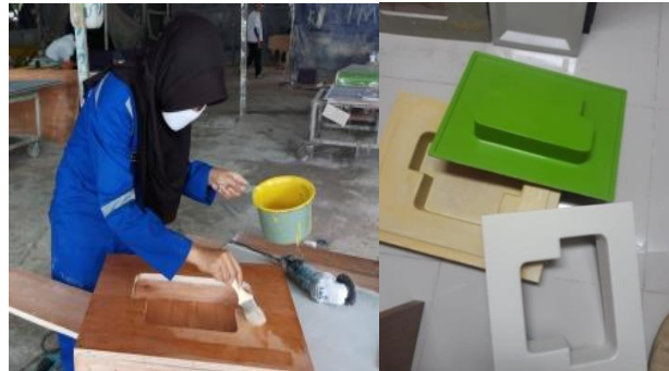
Gambar 2. Manufaktur Komposit Pada Komponen Dinding Interior Kereta Api PT.INKA
