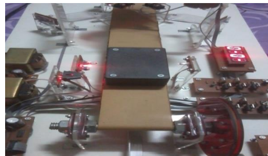
Gambar 28 sensor membaca benda hitam
