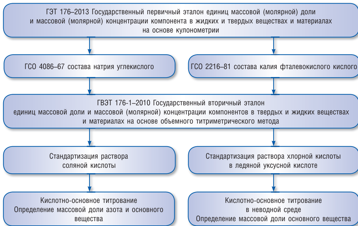
Рис. 4. Схема метрологической прослеживаемости
