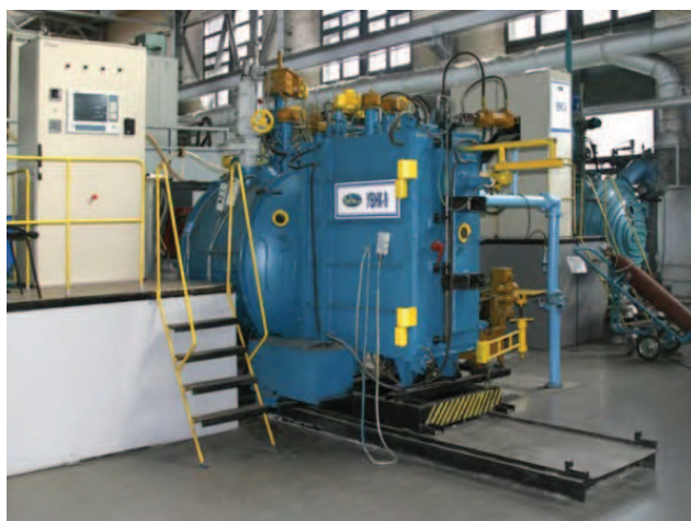
Рис. 4. Установка высокоградиентной направленной кристаллизации УВНК-9
