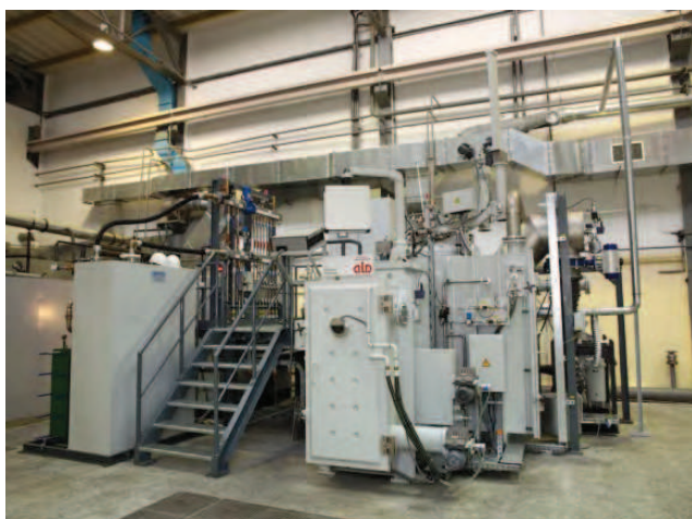
Рис. 3. Вакуумно-индукционная печь для выплавки ЖНС производства фирмы «ALD» (Германия)
