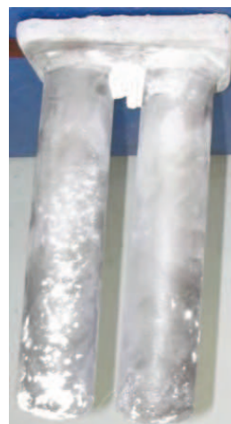
Рис. 8. Заготовки СО ЖНС, полученные методом направленной кристаллизации [9]
