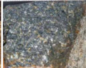
Auf dem Wolfsberg bei Lüptitz, der bis 161 Meter über den Meeresspiegel aufragt, befindet sich ein Steinbruch, in dem von 1864 bis 1930 Lüptitzer Pyroxengranitporphyr gewonnen wurde. Aufgrund seiner guten Bearbeitbarkeit wurde der Porphyr als Baumaterial, u. a. in Form von Pflastersteinen, geschätzt. Heute ist der Steinbruch mit Wasser gefüllt und dient als Angelgewässer. Der See
